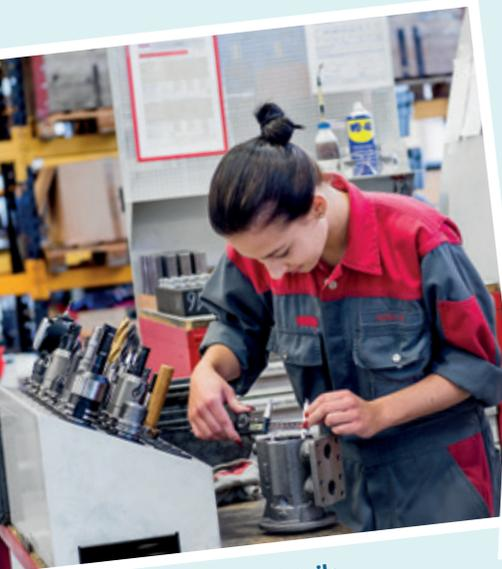
Ausmessen eines Frästeils
