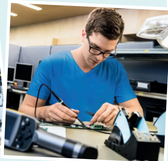
Ausmessen einer Leiterplatte
