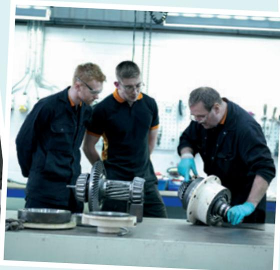
ein Getriebe wird zusammengebaut
