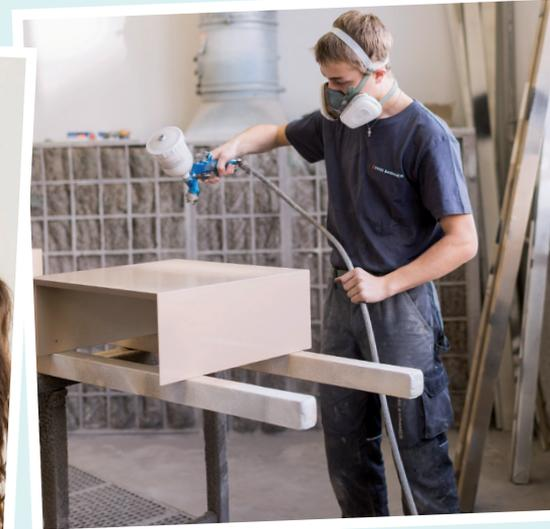
Werkstück aus Holz imprägnieren
