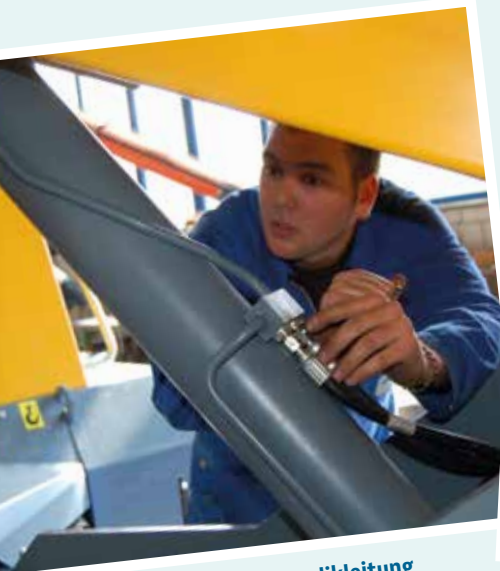
Montieren einer Hydraulikleitung
