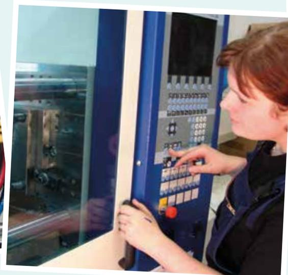
Bedienen einer CNC-Fertigungsmaschine
