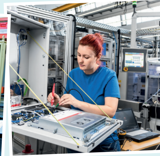
Fehlerquellen am Steuerungsgerät suchen
