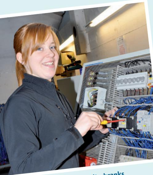
Verdrahten eines Schaltschranks
